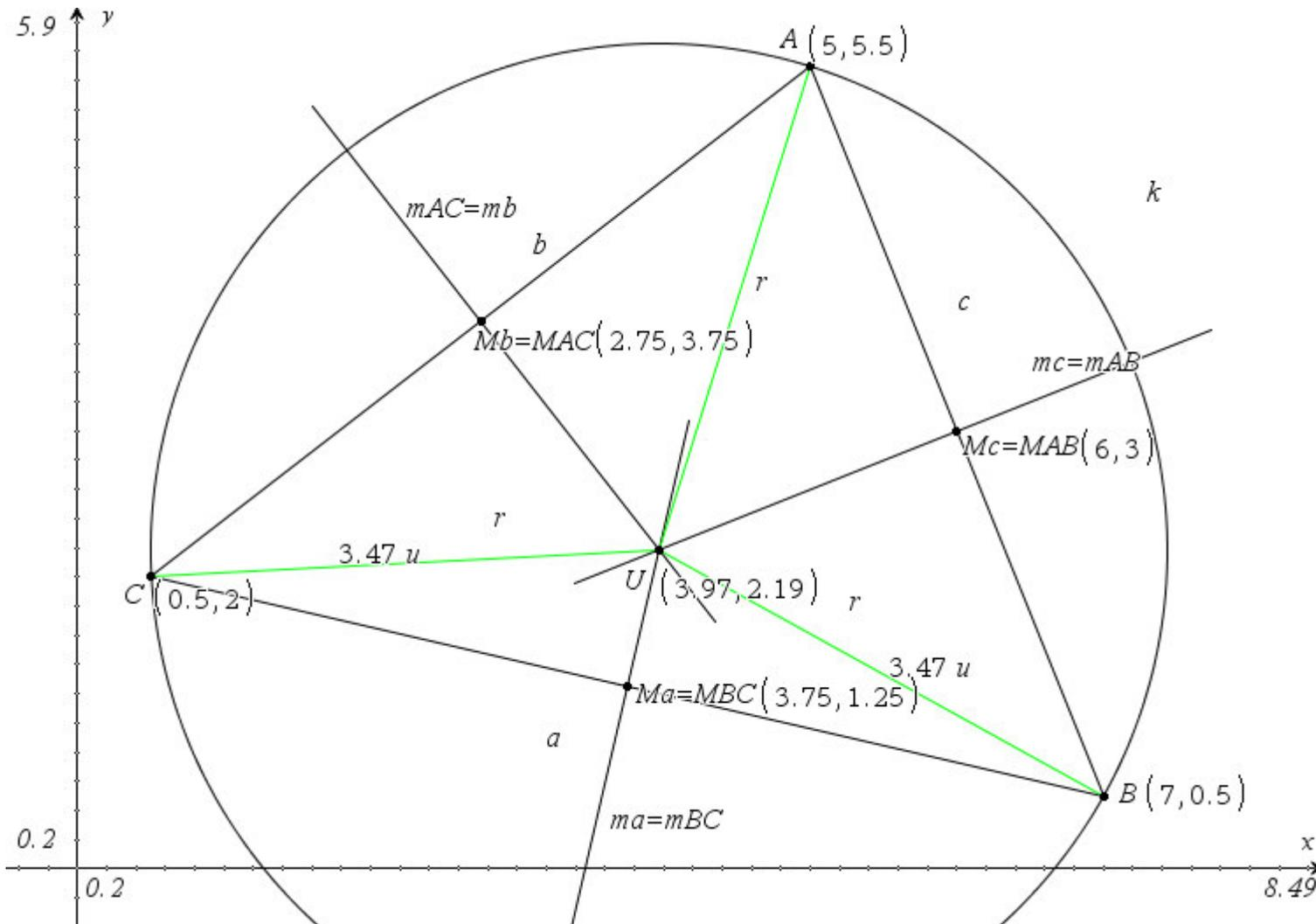
Beispiel für eine Konstruktion von U im stumpfwinkligen Dreieck
