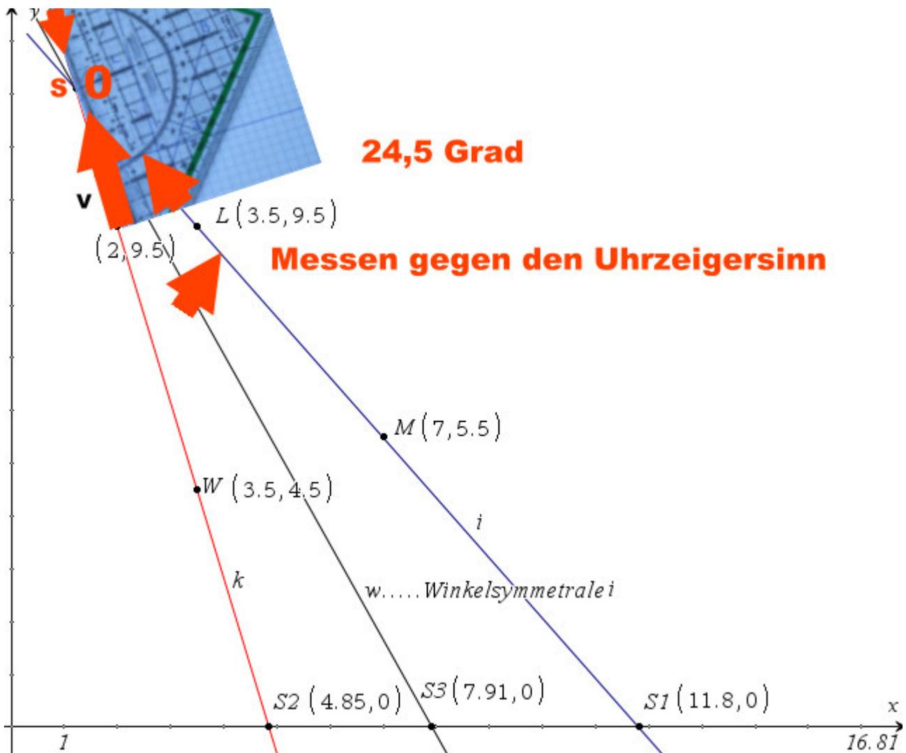
**Konstruktion der Winkelsymmetralen:**
