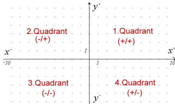
Die Beschriftung der Quadranten erfolgt **stets gegen den Uhrzeigersinn!**
